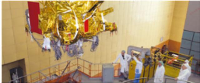
Космический телескоп «Спектр-РГ» — совместный российско-германский проект, который разрабатывался с 1990-х годов. Космический аппарат создан в НПО им. Лавочкина на базе платформы «Навигатор» (на той же платформе, что и радиотелескоп «Спектр-Р», он же «Радиоастрон», а также спутники серии «Электро»).
