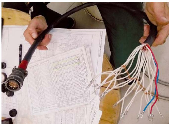
Только половина контактов в этом разьеме паяется штатно, остальные — адресно
