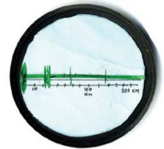
Схематическое изображение экрана РЛС «Редут-3» на котором указано 2 групповых цели на разном расстоянии
