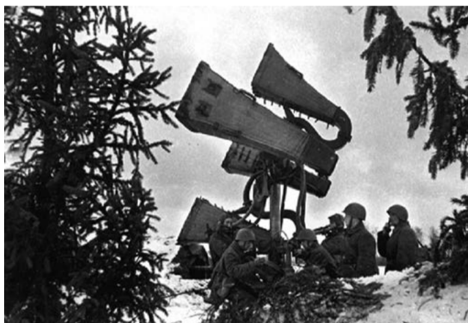
Приемное устройство звукоуловителя. Звукоуловитель не решал проблему раннего оповещения. Он позволял засечь самолет противника только на очень близком расстоянии или навести зенитный прожектор на цель
