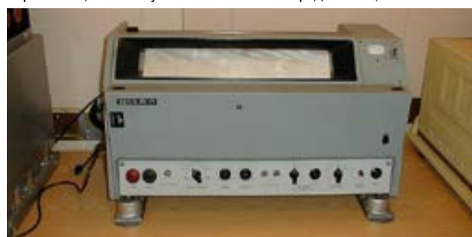
Фототелеграф «Иней-П» (работал совместно с РПУ «Циклоида») — рабочая лошадка гражданского флота СССР
