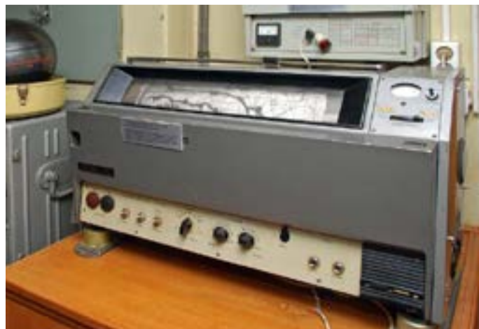
Передача и прием картографических изображений была главной работой фототелеграфов в армии и на флоте
