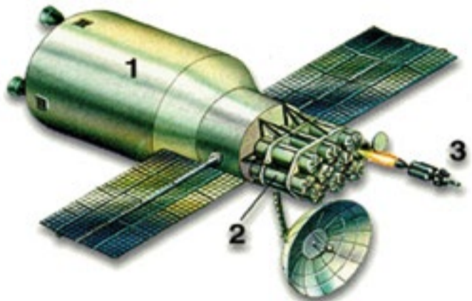
Система «Касад». 1 — базовый блок, включающий в себя агрегатный и приборно-топливный отсеки; 2 — бортовой комплекс вооружения; 3 — самонаводящаяся ракета
